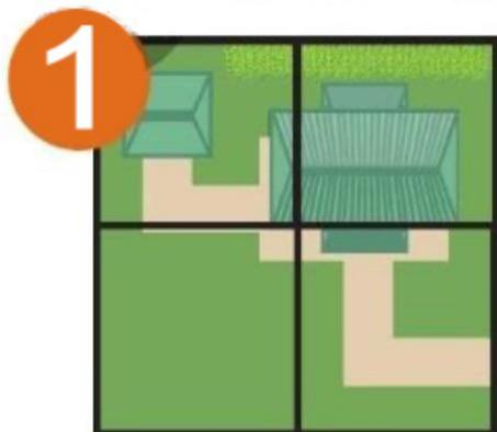
1 Elija un área de muestreo homogénea. Tome una muestra compuesta cada 30ha., formada por un mínimo de 20 extracciones.
